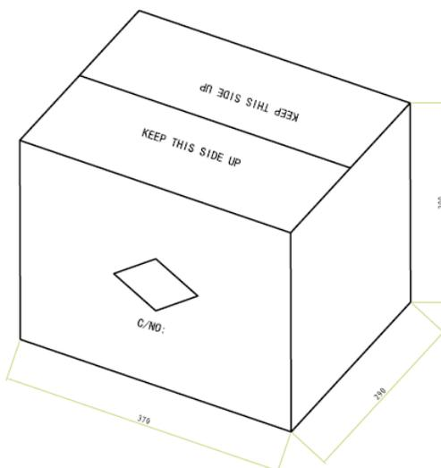
1. Package Box : L=370mm; W=290; H=300mm;
